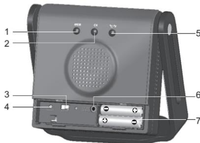
1. **MEM:** Aktuelle, maximale und minimale Temperatur anzeigen
