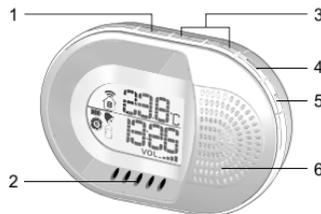
1. : Allume et éteint l'appareil; active le rétroéclairage
