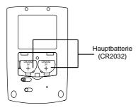
WARNUNG: Schalten Sie das Gerät vor dem Batteriewechsel aus. Wenn Sie die Batterien auswechseln während das Gerät eingeschaltet ist, kann das Gerät beschädigt werden. Wechseln Sie die Batterien innerhalb von 1 Minute aus, da andernfalls die Einstellungen für die Zeit, die Bezugsstadt und die Sprache für die Benutzerführung gelöscht werden, und Sie diese erneut programmieren müssen.
