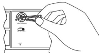
4. Ist die Funktion aktiviert, entspricht die Helligkeit der Hintergrundbeleuchtung 50 % der Normaleinstellung. Betätigen Sie die **SNOOZE/LIGHT**-Taste, um die volle Helligkeit zu erhalten.
