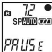
Die Aufnahme wird automatisch gestoppt, wenn zwei Sekunden oder länger kein Schall empfangen wurde.
