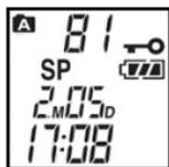
Durch diese Funktion werden alle Tasten gesperrt, sodass Wiedergabe und Löschen nicht möglich sind. Aktivieren Sie einfach **HOLD**. Durch ☞ wird angezeigt, dass alle Tasten gesperrt sind.
