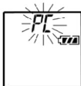
„PC“ wird angezeigt, wenn eine Verbindung hergestellt wurde. In diesem Zustand kann keine Taste verwendet werden.
