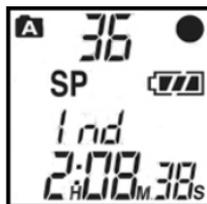
Drücken Sie während der Aufnahme ►►. Auf dem Display wird „Ind“ angezeigt.
