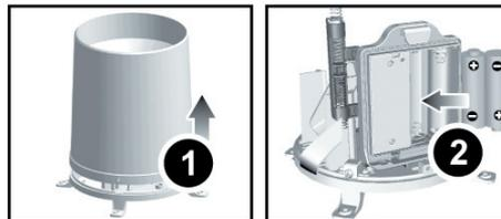
1. Entfernen Sie die Schrauben und ziehen Sie die Abdeckung nach oben hin vom Gehäuse ab.
