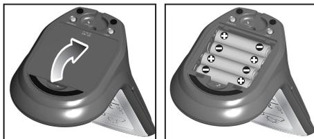
Installieren Sie die Batterien (4 x UM-3 / AA) der Basisstation und achten Sie auf die Übereinstimmung der Polarität + und -. Nach jedem Batteriewechsel auf **RESET** drücken.
