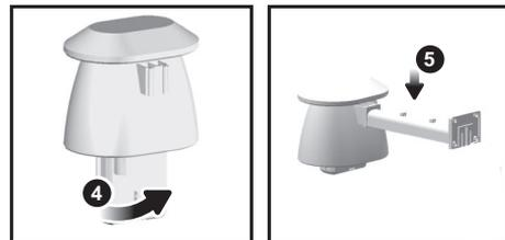
4. Stecken Sie die Sendeeinheit wieder in das Gehäuse, drehen Sie sie nach rechts und befestigen Sie sie, bis Sie ein Klicken hören.
