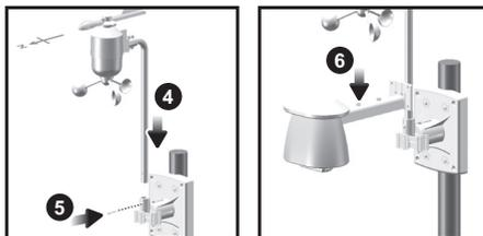
4. Insérer le capteur de vent dans le haut du collier.
