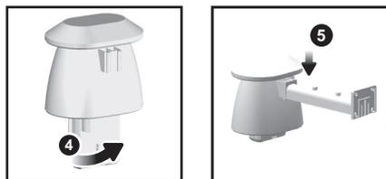
4. Insérer le capteur dans le boîtier, tourner et cliquer vers la droite pour bien fermer.
