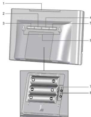
1. **SNOOZE · MESSAGE**: Permet d'activer le rappel d'alarme ; d'activer le rétroéclairage ; de choisir entre alerte météo/ conseil/ message horloge
