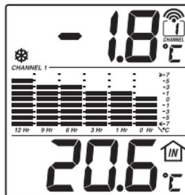
Si aucun signal n'est reçu, des blancs seront affichés. Appuyez sur **CHANNEL** et **MEMORY** simultanément pour forcer une nouvelle recherche. Ceci est utile pour synchroniser la transmission et la réception des unités principale et distante.
