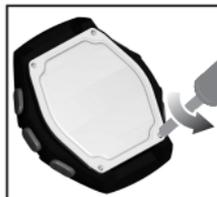
3. A l'aide d'un petit tournevis, retirez les quatre vis fixant le couvercle arrière.
