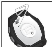
9. Réinitialisez la montre en insérant une pointe de métal dans la fente reset.
