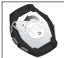
5. A l'aide d'une pointe, retirez la languette de fixation et soulevez le clip.
