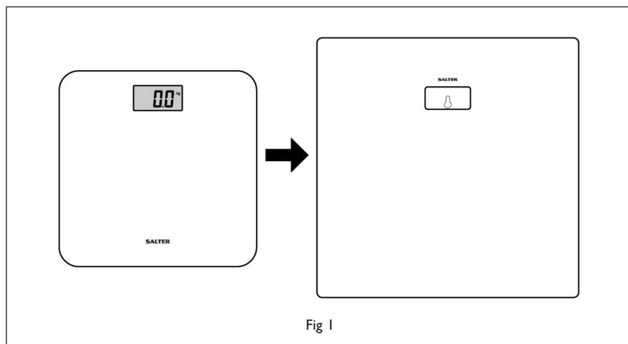
1. Når dette er tatt i betraktning, velg et passende sted for speilheten samtidig med at du sørger for at du har komfortabel tilgang til vekten. Beregn tilstrekkelig plass rundt speilheten til at du kan fjerne vekten og sette den på plass igjen (Fig. 1). Vekten kan fjernes eller settes på plass igjen fra begge sider.
